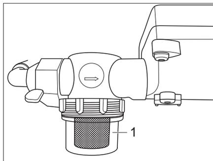
Bild 284 Wasserfilter der Druckwasserpumpe
