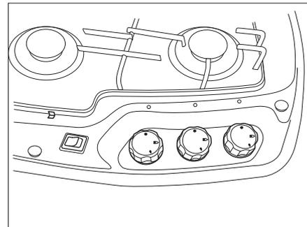
Bild 228 Bedienelemente für Gaskocher (Variante 4)
