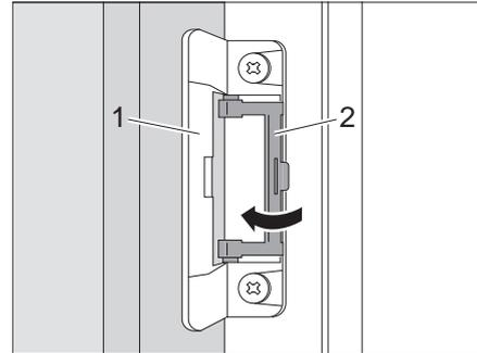
Bild 249 Lüftungsstellung arretieren
