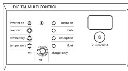
Der Wechselrichter ist eingeschaltet und liefert Leistung an die Verbraucher. Folgende Voralarme sind möglich:
