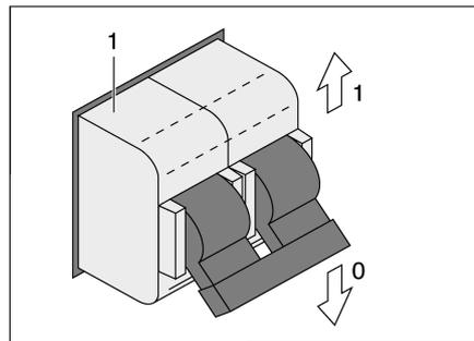
Bild 209 230-V-Sicherungsautomat
