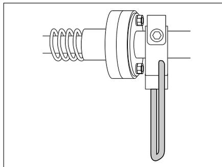
Bild 121 Sicherungshebel in Stellung gelöst
