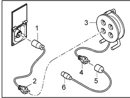
Bild 201 Anschlussmöglichkeiten 230-V-Anschluss
