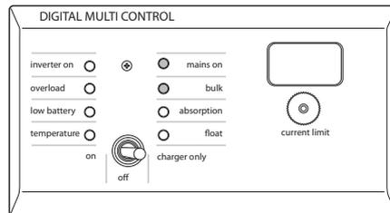
Die 230-V-Spannung liegt an. Das Ladegerät ist ausgeschaltet, da es nicht die Sollspannung erreicht (bulk protection Modus).
