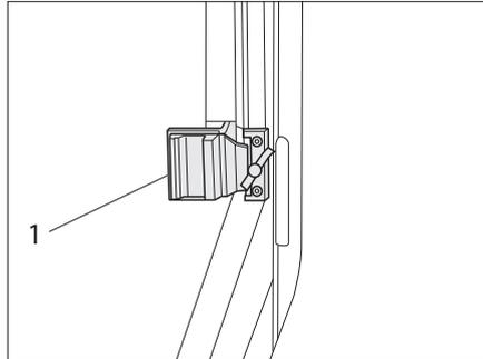
Bild 61 Schiebefenster mit Schieberriegelung
