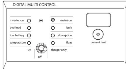
Die 230-V-Spannung liegt an. Das Ladegerät arbeitet im Konstantstrom- oder Konstantspannungs-Modus.
