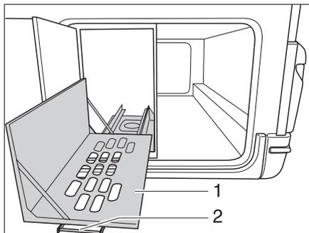
Bild 174 Gaskasten, mit ausziehbarem Schlitten (Variante 2)
