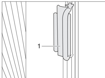
Bild 78 Griff faltverdunklung für die Frontscheibe
