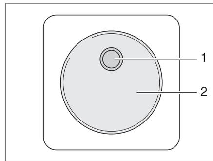
Bild 216 Bedienschalter Zusatz-Umwälzpumpe
