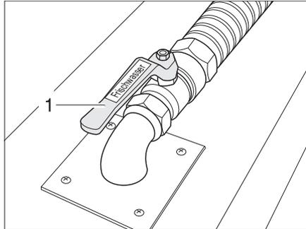
Bild 253 Ablaufhahn im Doppelboden
