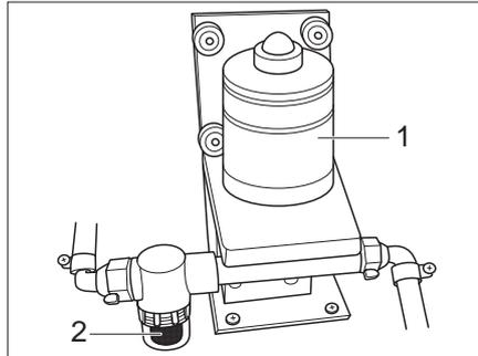
Bild 251 Druckwasserpumpe
