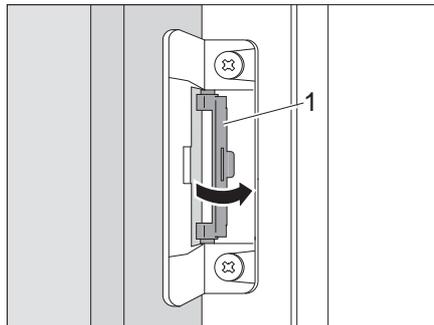
Bild 250 Arretierung in Ausgangslage zurück drehen
