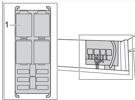
Bild 204 Fiat-Sicherungen im B-Holm unten auf der Beifahrerseite
