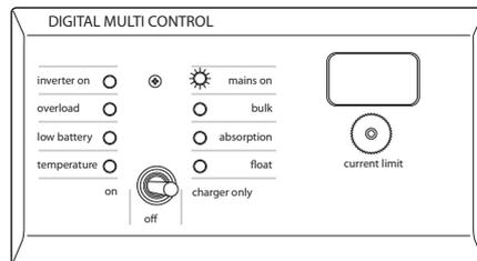
Die 230-V-Spannung liegt an. Das Ladegerät arbeitet im Spannungs-Erhaltungsmodus.
