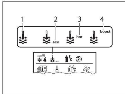
Bild 197 Einstellmöglichkeiten Warmwasser
